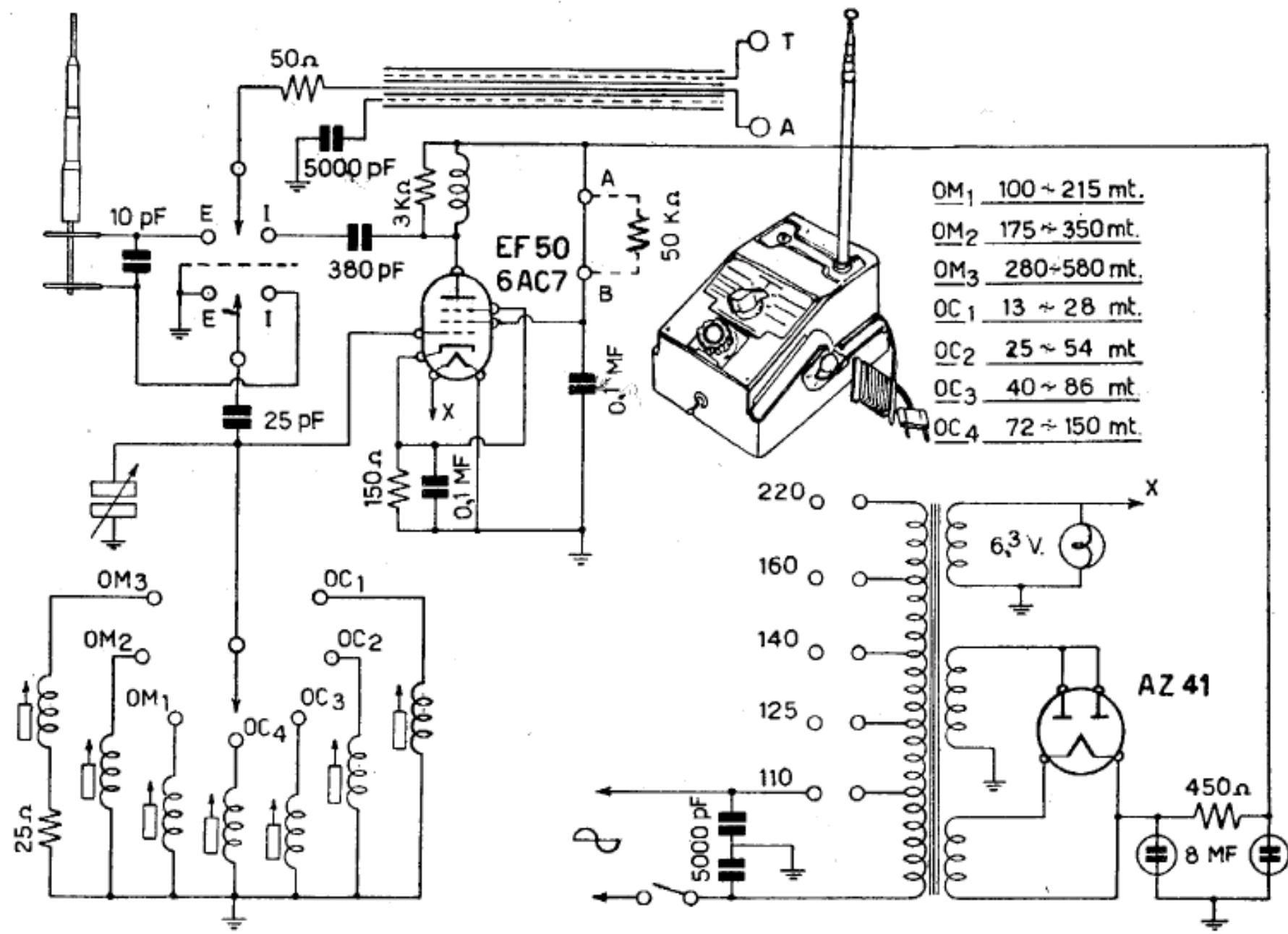
ZENITRON RADIO - Mod. Radio Pilota - Preamplificatore ad alta frequenza (booster) da collegare all'entrata di qualsiasi apparecchio radio per aumentarne la sensibilità. Gamma da 12,5 metri a 600 metri, suddivisa in tre campi d'onda media e quattro campi d'onda corta.
